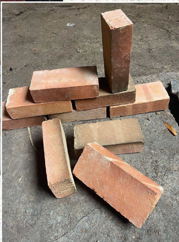
Gạch Đinh Xây Không Trát 220x100x65(mm)
