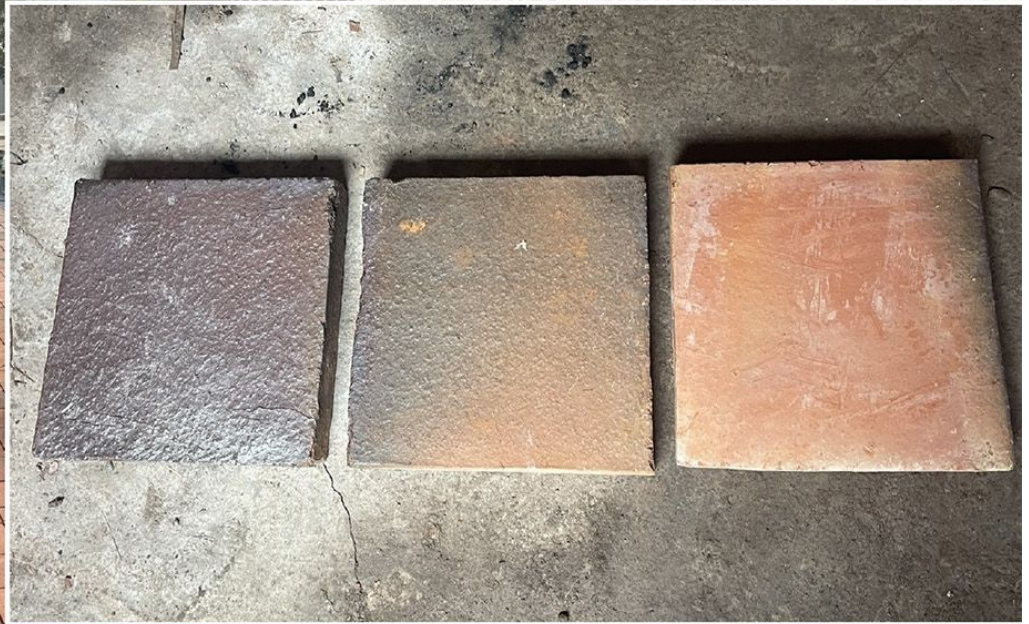
Gạch Gốm Cổ Lát Nền 300x300x50(mm)
